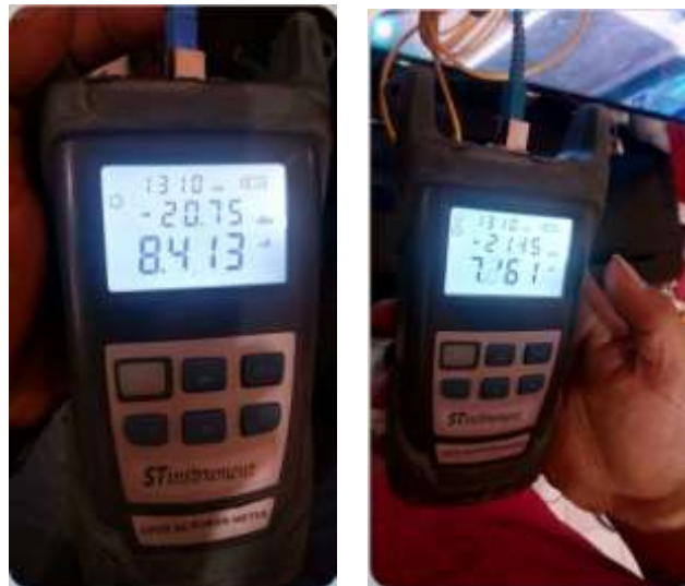
Gambar 5. Hasil Pengukuran Power Budget di Bagian Input dan Output OTP
